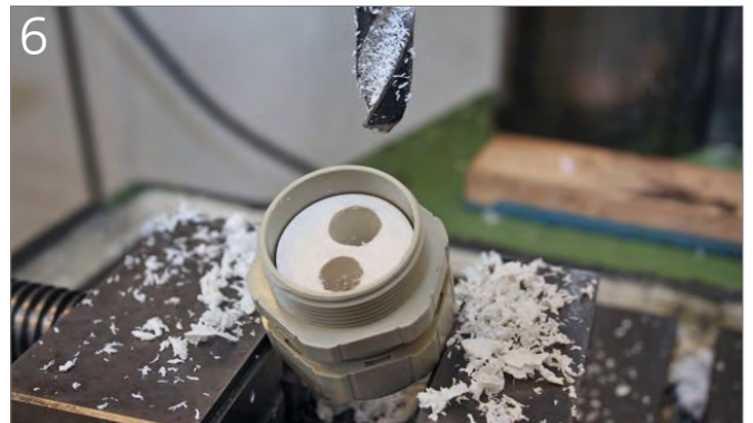
6 Zweite Bohrung in der Ansicht von unten
