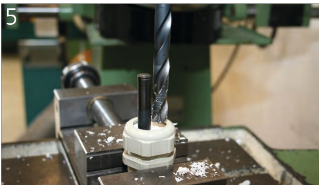
5 Bei Anfertigung eines zweiten Bohrloches ist das erste mit einem Bohrer oder mit einem passenden Bolzen zu verschließen, um dem Dichteinsatz eine Formstabilität zu geben.
