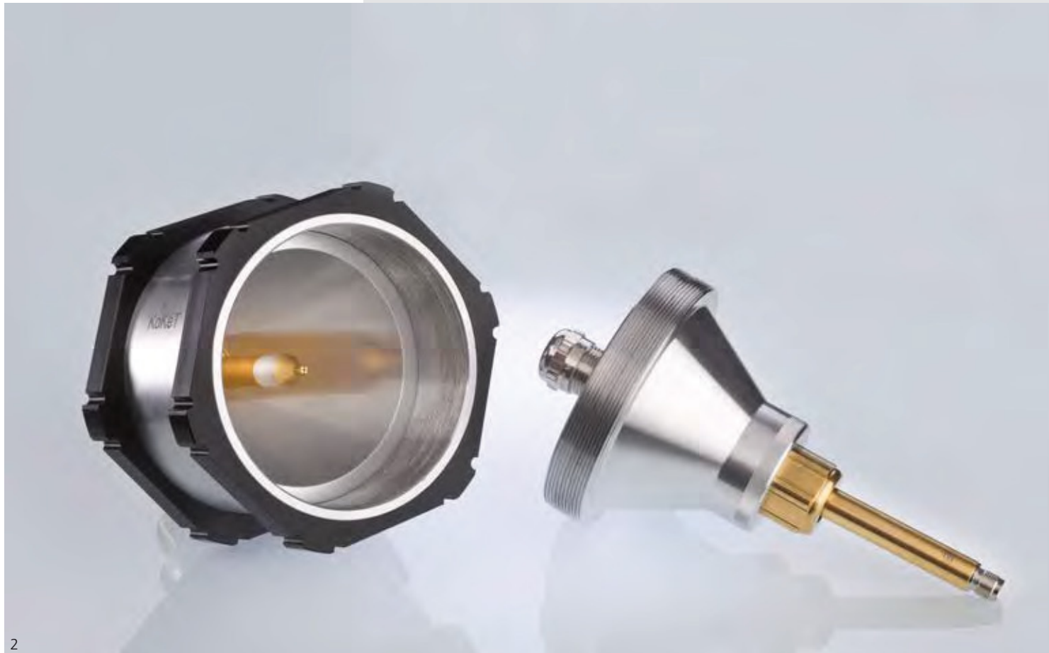
Abb. 1 – KoKeT - Messvorrichtung für die Schirmwirkung von EMV-Kabelverschraubungen Fig. 1 – KoKeT - measuring device for the screening effect of EMC cable glands
