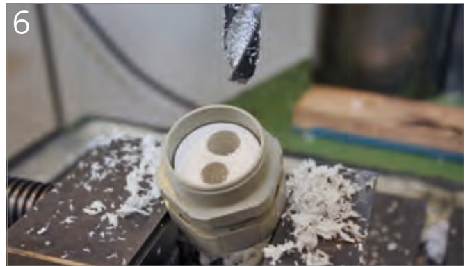
6 Zweite Bohrung in der Ansicht von unten
