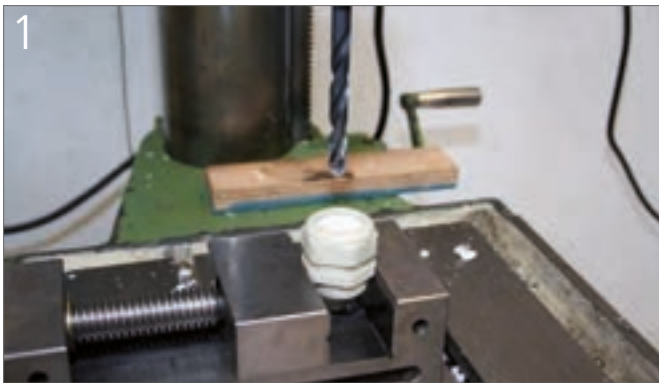
1 Montage des Dichteinsatzes in einem passenden Verschraubungskörper
