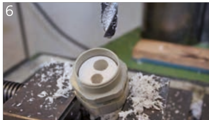
6 Zweite Bohrung in der Ansicht von unten
