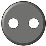
Abb. 3 – Beispiel „2 x 3“ 2 = Anzahl Bohrungen 3 = Bohrungsdurchmesser in mm Fig. 3 – Example “2 x 3” 2 = Number of holes 3 = Hole diameter in mm
