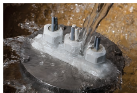
Abb. 2 – der UNI FLANSCH bei der Wasserschutzprüfung Type 4X Fig. 2 – UNI flange during a water ingress test Type 4X
