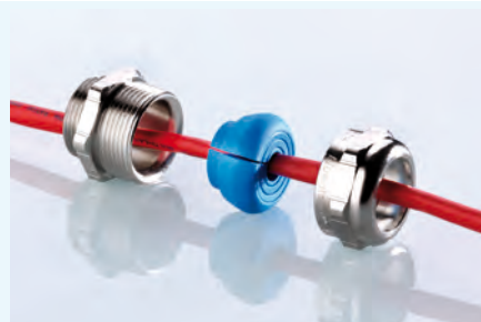
blueglobe® mit Mehrfach-Inlet geschlitzt für die Montage von konfektionierten Kabeln IP 68 bis 15 bar Ausführung „geschl.“ blueglobe® with multiple-inlet slotted for the installation of preassembled cables IP 68 up to 15 bar Model „geschl.“
