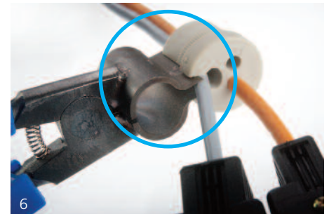
Abb. 6: Das Einlegen der Kabel in die geschlitzten Mehrfachdichteinsätze wird mit der Sprezzange erleichtert. Fig. 6: Placing the cable into the slotted multiple sealing inserts is made easier with the expanding pliers.
